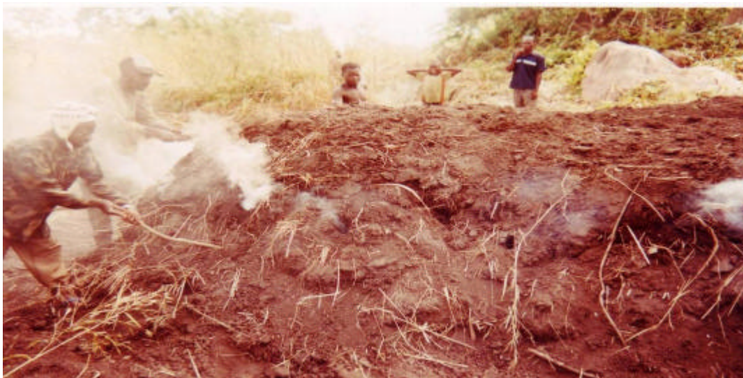
Photo 22 : Dégagement de fumée blanchâtre par les événements d'une meule aérienne à Klaklagon
