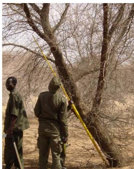
Mesure de hauteur à la perche télescopique
