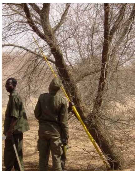
Mesure de hauteur à la perche télescopique
